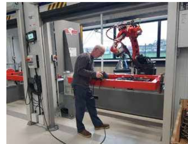
De laatste nieuwe robots voor de hakencel, sinds eind 2019 in productie. Elke robot staat op een baan en kan hierdoor 3 lasplaatsen bereiken.
