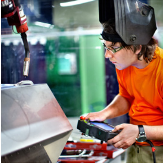
Svetsrobotar kan programmeras med hjälp av en programmeringskonsol
