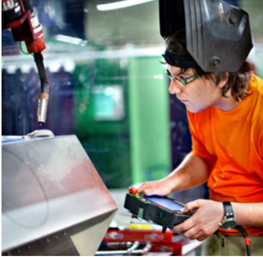
Programmation en ligne avec le boîtier de programmation
