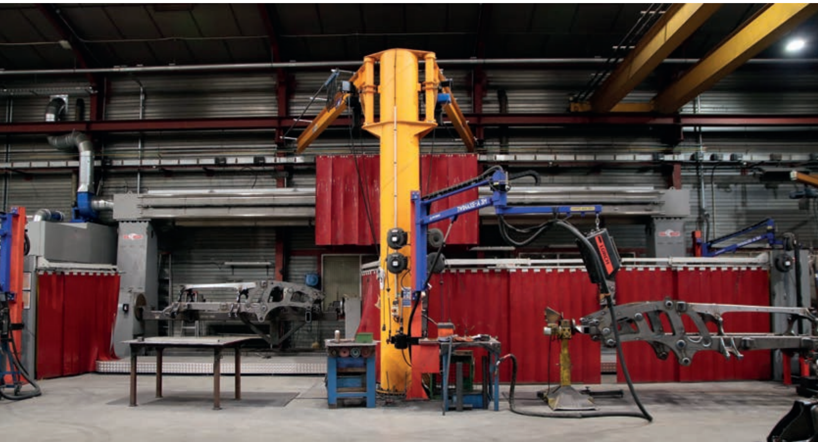
Ensimmäinen Valk Weldingin Comebo Industriesille kehittämä solu perustuu robottiportaaliin jossa robotti on ylösalaisin, mitat kasvoivat jopa 5 metriä, edellisen koneen 3,2 metrin sijaan.
