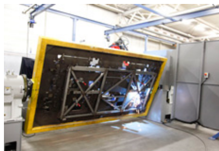
Dwarsdoorsneden worden nu door de lasrobot afgelast....
