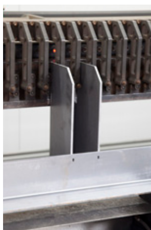
Leds op de mal geven aan waar de operator de dragers moet plaatsen
