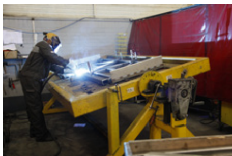
Dwarsdoorsneden werden tot voor kort handmatig gelast
