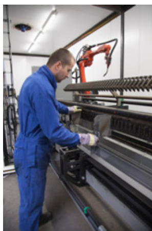
Leds op de mal geven aan waar de operator de dragers moet plaatsen
