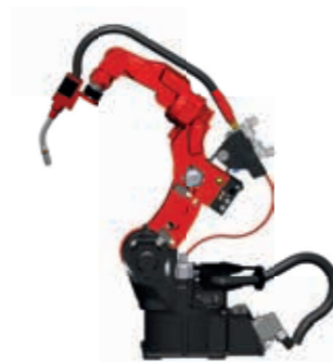
Externí kabelový svazek
