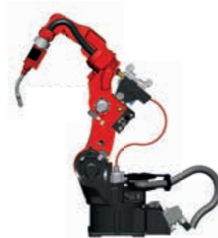
Interní kabelový svazek
