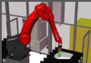
Le robot coupe le bord à souder sur les tôles
