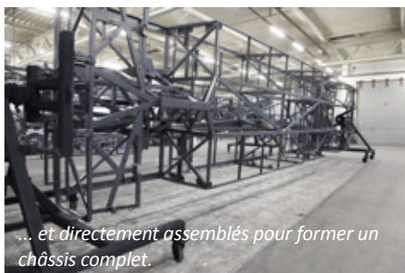
Aujourd'hui, les longerons sont soudés par le robot de soudage ...
