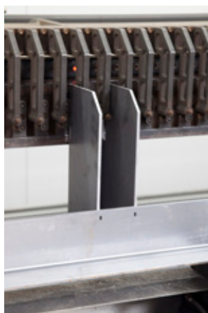
Les LED présentes sur le gabarit indiquent où l'opérateur doit placer les supports
