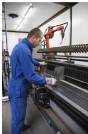
Les LED présentes sur le gabarit indiquent où l'opérateur doit placer les supports
