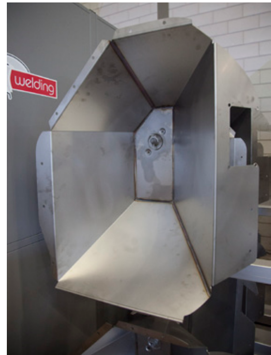
Un produit en acier inoxydable soudé à l'extérieur et entièrement soudé à l'intérieur.
