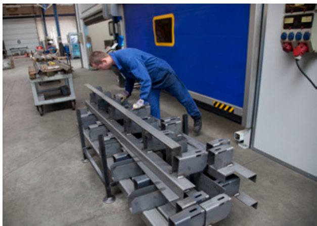
Les supports sont placés sur les poutres sans fixation préalable
