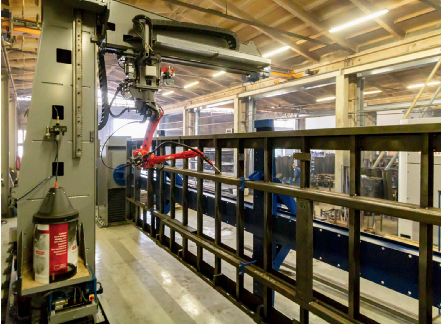
4200 mm einzusetzen. Mit dem Einsatz dieser Schweißroboteranlage konnte das Unternehmen die Schweißproduktion dieser Chassis verdoppeln. Aufgrund dieses Erfolgs beschloss Metal-Fach, die Anlage mit einem zweiten Schweißroboter zu erweitern, um die Möglichkeiten der Anlage voll auszuschöpfen.
