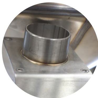
Element spawany metodą TIG, bez podawania drutu
