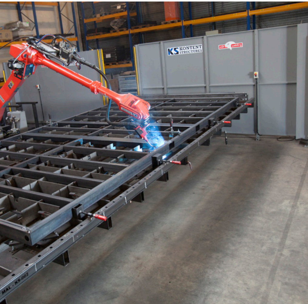
Robot spawalniczy Panasonic HH-020L ma niespotykany zasięg 3281 mm
