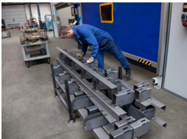
Držáky se připevní na nosník bez speciální fixace
