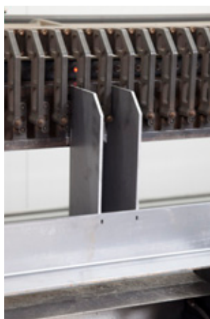
LED na přípravku ukazuje, kde má operátor umístit držáky
