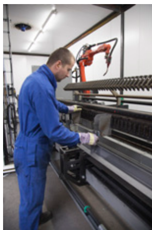
LED na přípravku ukazuje, kde má operátor umístit držáky
