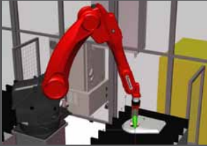
Der Roboter schneidet Schweißkanten an Blechteile
