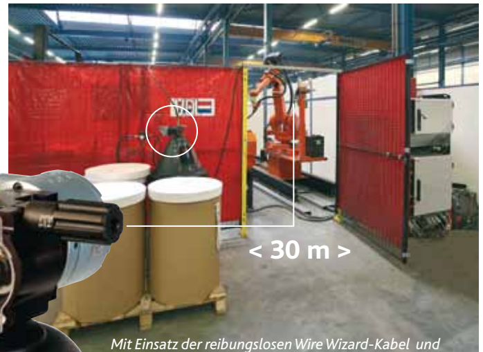
Mit Einsatz der reibungslosen Wire Wizard-Kabel und den Pneumatic Feed Assistant (PFA) kann Schweißdraht größere Entfernungen überbrücken.
