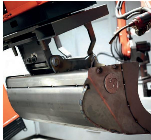
Es wurden umfangreiche Entwicklungsarbeiten an den Vorrichtungssystemen durchgeführt, um einen möglichst automatisierten Schweißprozess zu erreichen.
