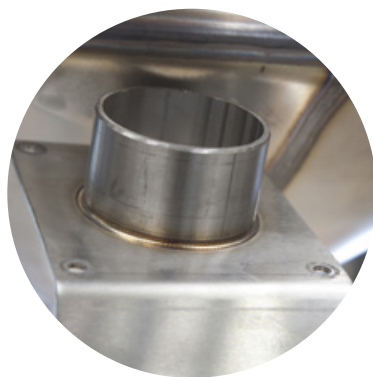
Svejsning med TIG uden trådforsyning
