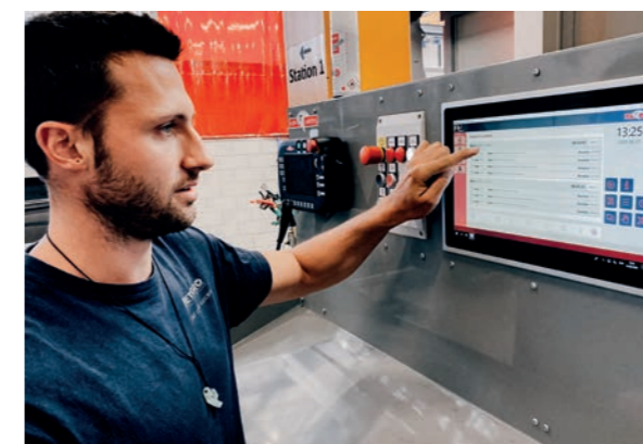
Auf dem Display laufen alle Daten zusammen, so dass jeder Produktionsschritt im ERP-System erfasst werden kann.
