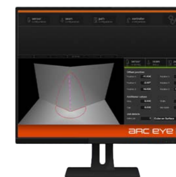
3D Seam-Finding: analiza wyszukiwania i lokalizacji pozycji punktu w jednym kroku.
