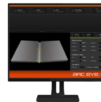
3D Seam-Finding (początek spoiny): na powyższym zdjęciu przedstawiono punkt początkowy, kierunek i wymiary rowka V, które są wyszukiwane i znajdowane w jednym kroku.
