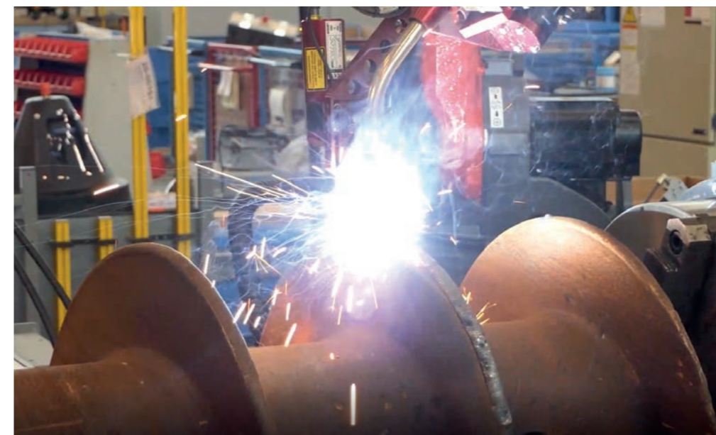
Nakładanie na siebie kilku warstw, do 30 mm
