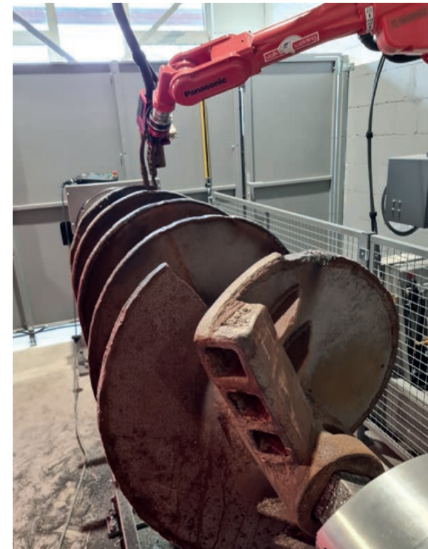
Arc-Eye kontroluje prowadzenie palnika
