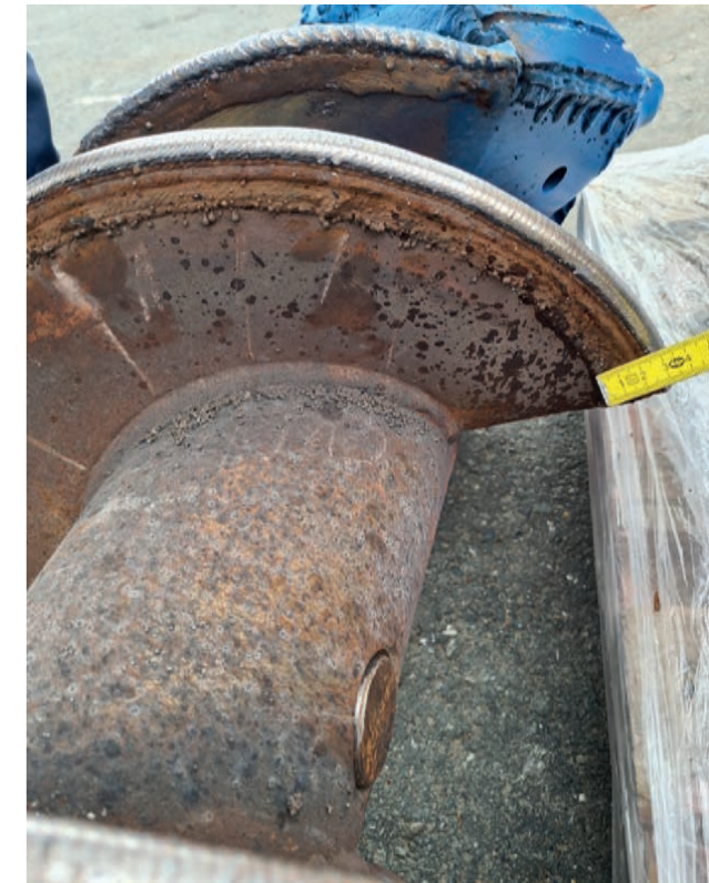
Kolejność zużycia w segmentach
