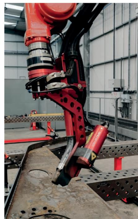
**"L'ajout de manipulateurs donne encore plus de flexibilité pour le soudage des assemblages."**
