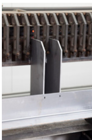
Diody LED na formie pokazują, gdzie operator musi umieścić nośniki
