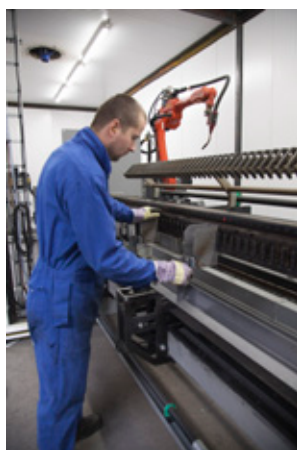
Diody LED na formie pokazują, gdzie operator musi umieścić nośniki
