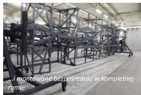
Obecnie przekroje poprzeczne są spawane przez robota spawalniczego...
