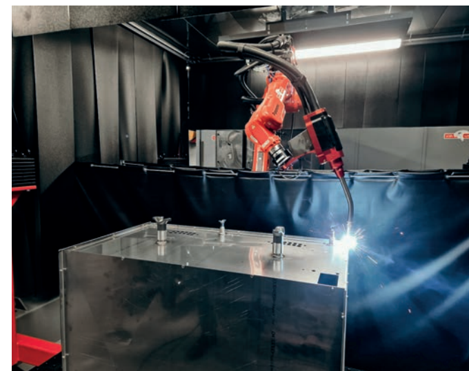
Chez Eurofours, Valk Welding a installé une solution reposant sur un châssis en H monobloc, un robot TL-1800 et un générateur intégré doté de l'option SAWP de Panasonic.
