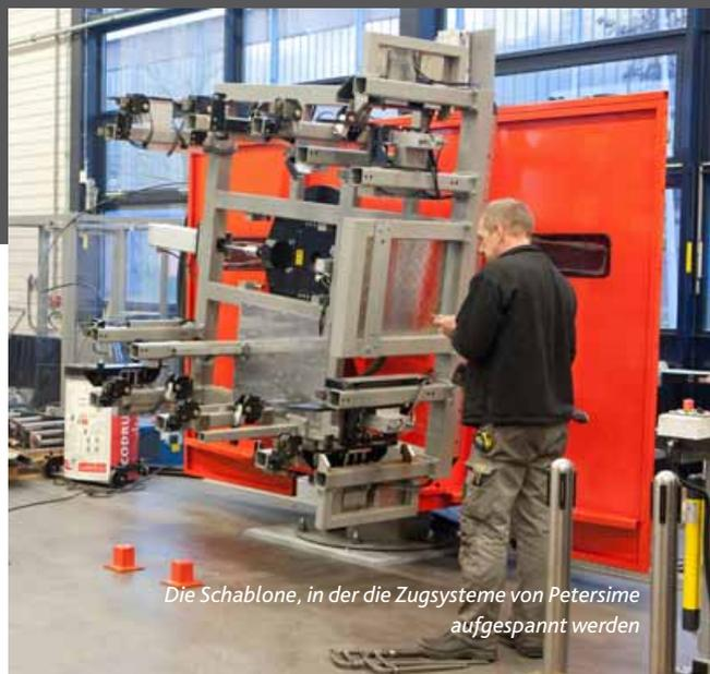
Die Schablone, in der die Zugsysteme von Petersime aufgespannt werden
