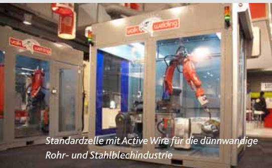
Standardzelle mit Active Wire für die dünnwandige Rohr- und Stahlblechindustrie
