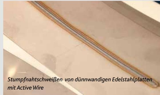
Stumpfnahtschweißen von dünnwandigen Edelstahlplatten mit Active Wire
