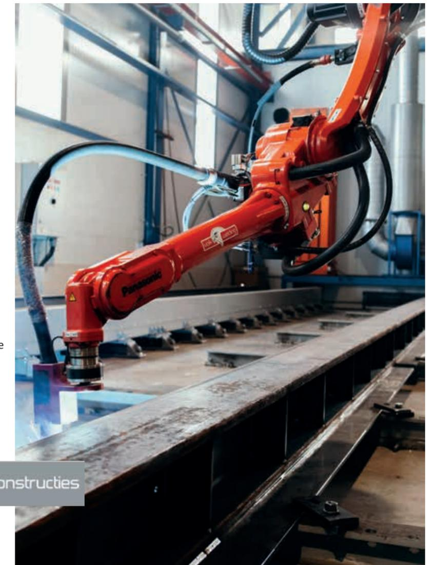
Le robot soude maintenant des poutres d'angle composites SFB de 15 m de long en 3 heures
