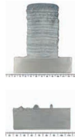
Figure 1. Evolution du processus, de simples cordons jusqu'à un bloc imprimé en 3D
