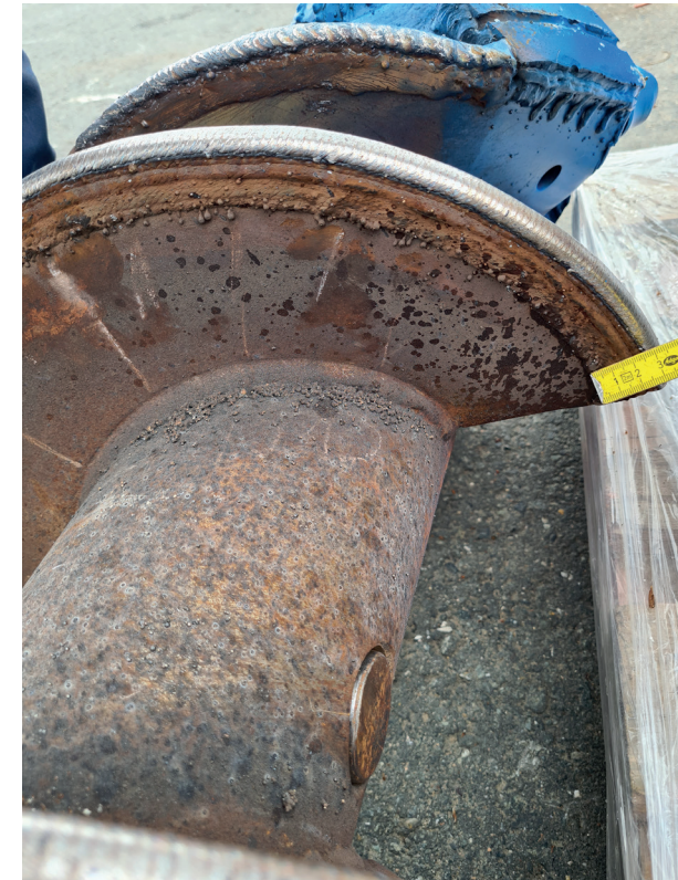
Verschleißauftrag in Segmenten
