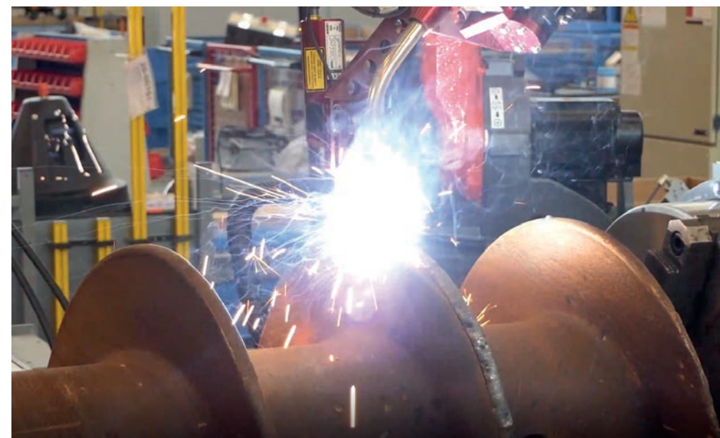
Verschleißauftrag von mehreren Schichten, bis zu 30 mm
