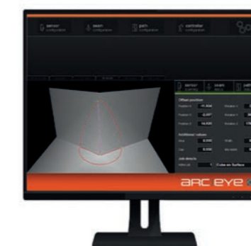
Relocalisation 3D "3D Seam-Finding": L'extrémité du cordon est recherchée et trouvée en une seule opération.
