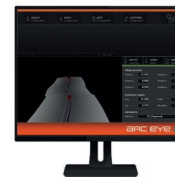
Suivi de joint 3D "3D Seam-Tracking": Au cours de ce suivi, le robot sera guidé via un environnement scanné en 3D.
