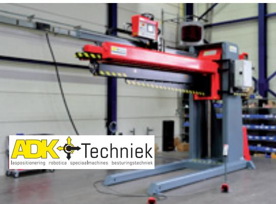
Vor kurzem hat ADK Technik für ein niederländisches Unternehmen einen höhenverstellbaren Schweiß- und Spanntisch für das mechanisierte Verschweißen von Behälterteilen aus gewalzten Edelstahlblechen für die industrielle Verwendung gebaut. Der Schweiß- und Spanntisch ist für Behälterteile bis zu  $\varnothing$  2.500 mm und einer Länge von 3.500 mm geeignet.
