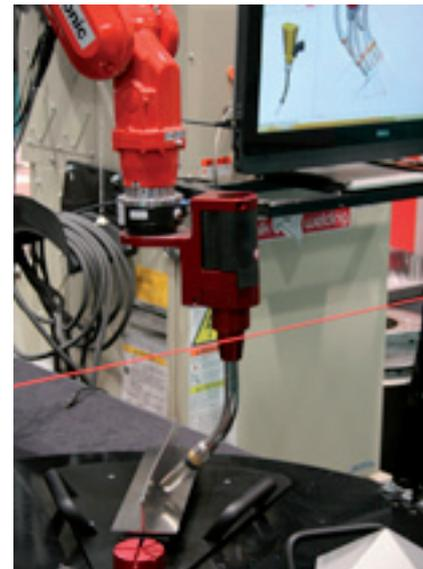
*Die Software erstellt aus den Daten ein Programm für den Schweißroboter.*
