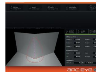
**3D-Naht-Findung:** Der Scheitelpunkt wird in einem Suchvorgang gesucht und gefunden.
