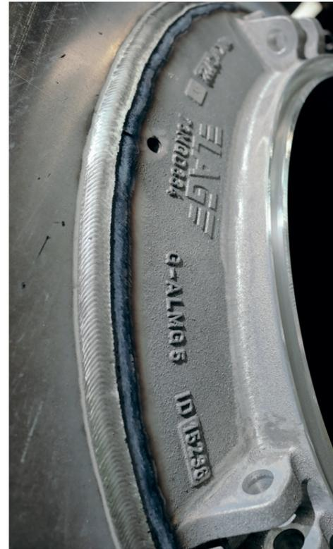
**ARC-EYE Adaptive - Die Fähigkeit des Roboters, die Schweißparameter automatisch an Änderungen der Fugengeometrie anzupassen.**
