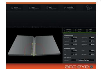
**3D-Naht-Findung (Beginn einer Schweißnaht):** Der Startpunkt, die Richtung und die Abmessungen der V-Naht werden in einem Suchvorgang gesucht und gefunden.
