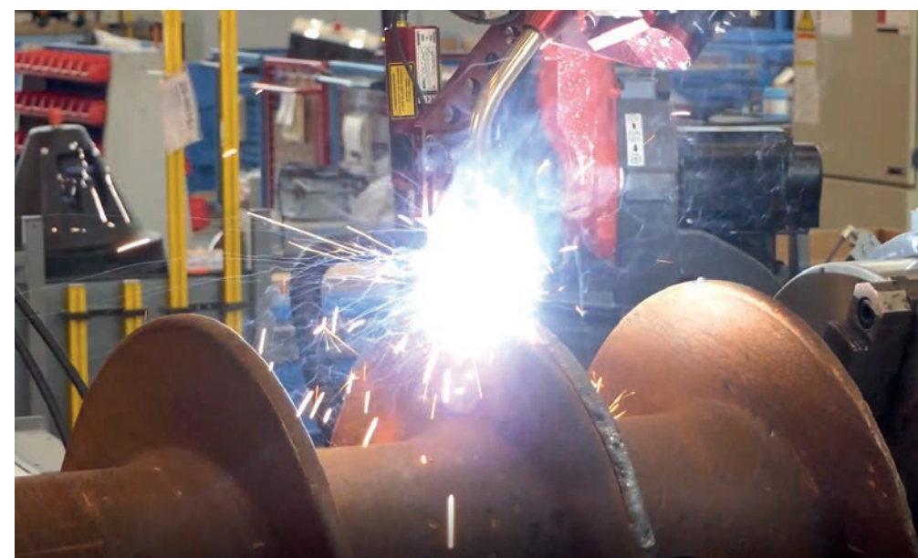
Opotřebení několika vrstev až do tloušťky 30 mm
