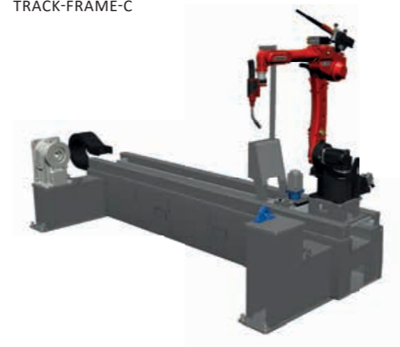
TRACK-FRAME-C-MCB (liikuteltava laakeroitu vastapylkä)
