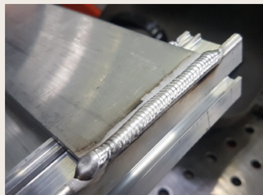
Aluminiumdörr svetsad med Stitch Pulse
