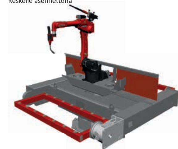
FRAME-IT+H kääntöpöydällä ja robotti keskelle asennettuna
