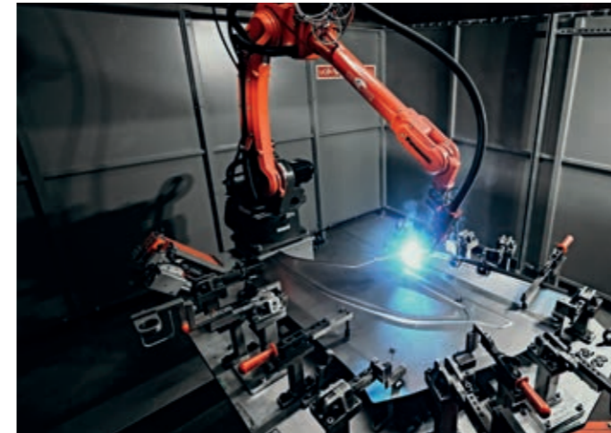
Schweißen von Blechunterbaugruppen
