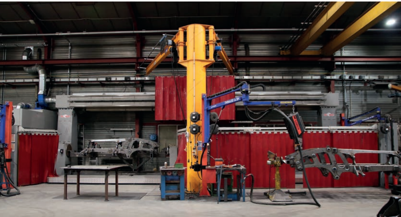
Die erste Zelle, die von Valk Welding für Comebo Industries entwickelt wurde, basiert auf einem hängenden Roboter an einem Portal, für Abmessungen bis zu 5 Meter, anstatt 3,2 Meter mit der vorherigen Maschine.
