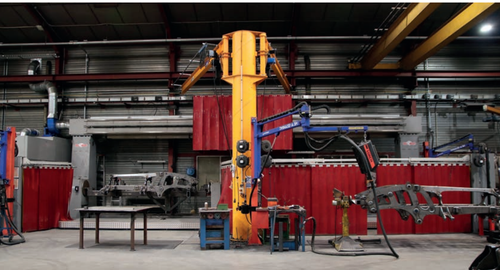
Den første celle udviklet af Valk Welding for Comebo Industries er baseret på en hængende robot på en portal, for dimensioner op til 5 meter, i stedet for 3,2 meter med den tidligere maskine.
