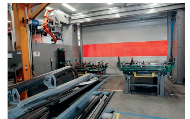
Alla delar till en vägg-, golv- eller taksektion levereras kompletta i en uppsamlingsvagn
