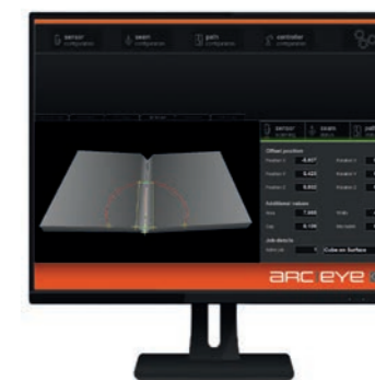
3D Seam-Finding (start van een lasnaad): in het bovenstaande beeld worden het startpunt, de richting en de afmetingen van de V-groef in één zoekopdracht gezocht en gevonden.
