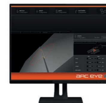
3D Seam-Analysis: de lasnaad wordt in de 3D weergave geanalyseerd en gecontroleerd.
