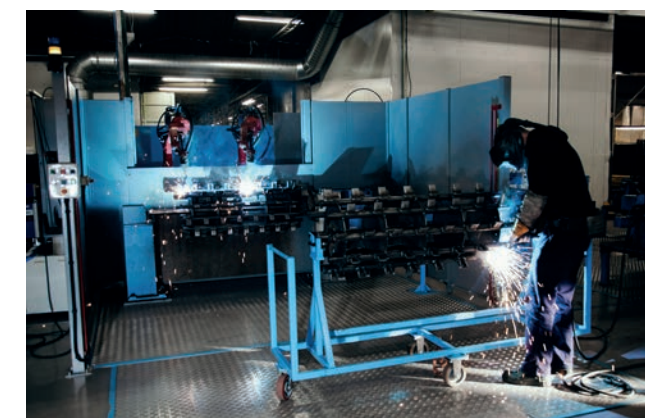
Podczas gdy operator czeka na robota spawalniczego, w międzyczasie wykonuje on ręczną operację spawania.
