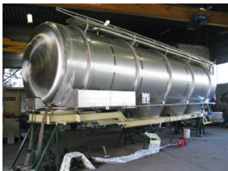
Væskebeholdere i rustfrit stål, som Hazeleger færdigsvejer automatiseret ved hjælp af langsøm- og rundsømsvejsmaskinen fra ADK Techniek.
