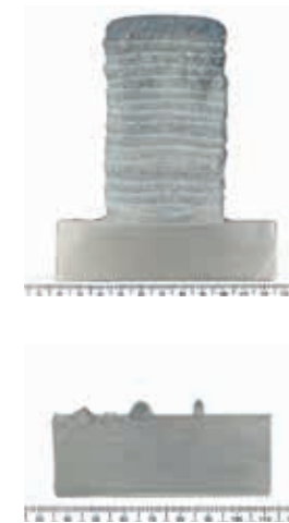
Figuur 1. Opschalingsproces van enkele parels tot 3D-geprint blok
