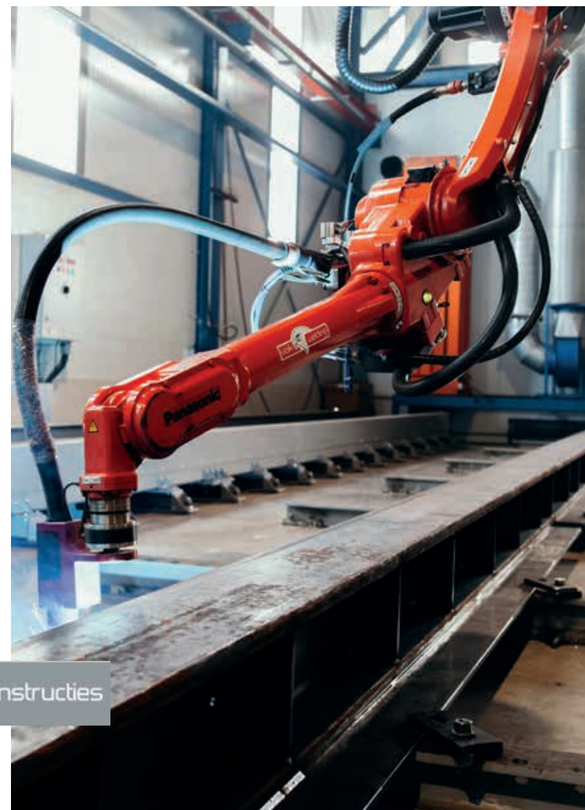
De robot last 15 meter lange SFB samengestelde hoekliggers nu in 3 uur.
