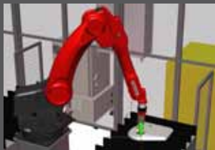
Robot snijdt laskant aan plaatdelen
