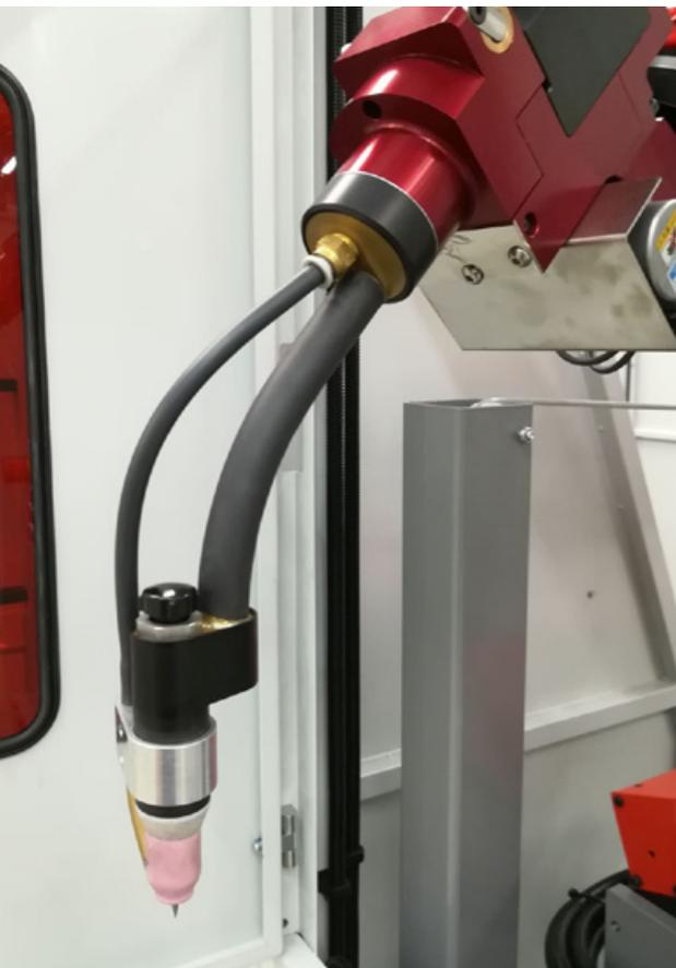
VWPR QE SERVO PULL WIG II Roboterbrenner
