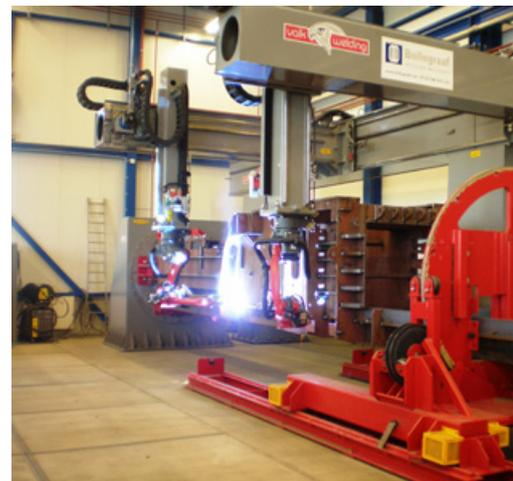
Panasonic TA1900-WG Schweißroboter in einer Portalkonstruktion. Die großen Rahmen der Pressen werden von einem 25 Tonnen schweren Manipulator positioniert und von zwei Robotern in 21 Stunden gleichzeitig verschweißt. Für das manuelle Schweißen der Rahmen mit 3-lagigen Kehlnähten benötigten die Handschweißer insgesamt 2 Wochen (inklusive Nachbearbeitung).
