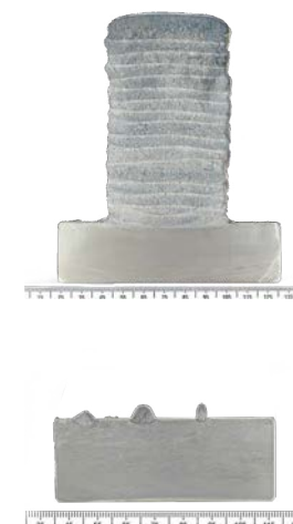
Obrázek 1. Proces zvětšení z jednotlivých housenek na 3D tištěný blok
