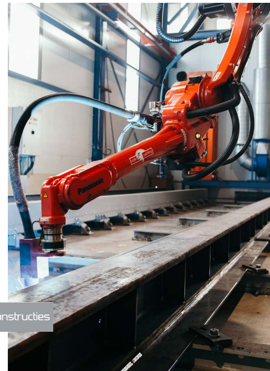
Robot nyní svařuje 15 m dlouhé složené rohové nosníky SFB za 3 hodiny
