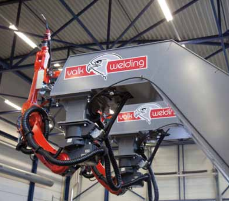
Für den dänischen Hallenbauer Thyssen Staal lieferte Valk Welding eine Roboteranlage für die Herstellung von zusammengestellten Gebinden in Einzelfertigung.
