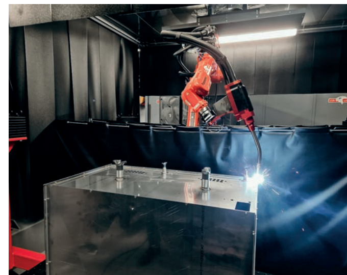
W Eurofours firma Valk Welding zainstalowała rozwiązanie składające się z koncepcji Valk Welding FRAME-H, robota TL-1800 oraz zintegrowanego źródła prądu z procesem spawania Super Active Wire firmy Panasonic.
