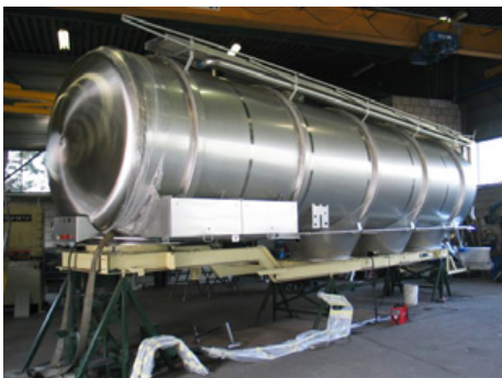
De RVS vloeistoftanks die Hazeleger met de langs- en rondnaadlasmachine van ADK Techniek geautomatiseerd af gaat lassen.
