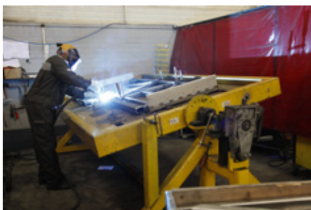
Bis vor kurzem wurden Profile manuell geschweißt.
