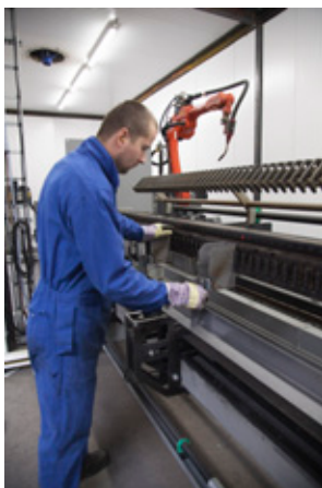
LEDs auf der Schablone zeigen an, wo der Bediener die Stützen platzieren muss.
