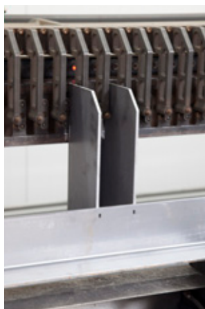
LEDs auf der Schablone zeigen an, wo der Bediener die Stützen platzieren muss.
