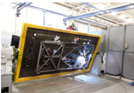
Heute werden Profile vom Schweißroboter verschweißt ...
