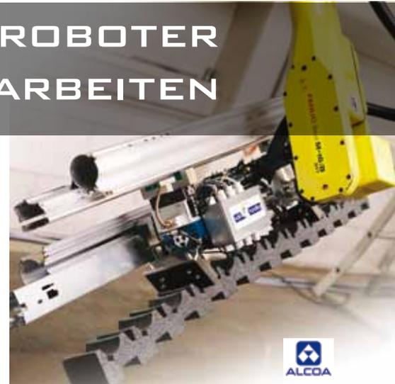
Valk Welding erwartet für die kommenden Jahre die Zunahme des Einsatzes von Plasmaschneiderrobotern zwecks anderer Anwendungen. Gerade beim Kürzen und Schneiden der Löcher in die Schächte und Rohre ist der Schneiderroboter um Vieles schneller und genauer als die herkömmlichen Bohr-, Säge- und Fräsmaschinen.
