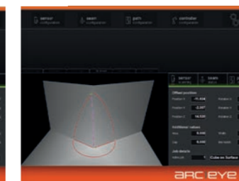
Recherche de cordons de soudure en 3D : L'extrémité du cordon est recherchée et trouvée en une seule fois.
