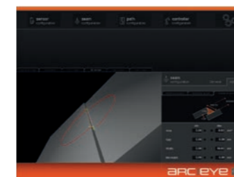
Analyse 3D du cordon de soudure : Le cordon de soudure est analysé et contrôlé en 3D.
