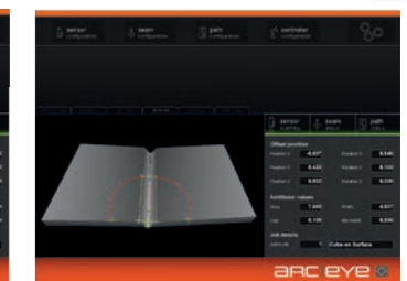
Recherche de cordons de soudure en 3D (début d'une soudure) : Le point de départ, la direction et les dimensions du chanfrein en V sont recherchés et trouvés en une seule fois.
