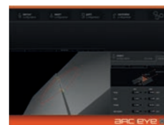
Analiza spoiny 3D: Ścieg spawalniczy jest analizowany i sprawdzany w widoku 3D.
