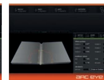
3D Seam-Finding (początek spoiny): Punkt początkowy, kierunek i wymiary rowka V są wyszukiwane i znajdowane w jednym wyszukiwaniu.
