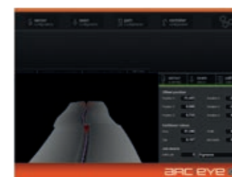
Śledzenie spoiny 3D: Podczas śledzenia spoiny robot jest prowadzony przez zeskanowany obraz 3D.
