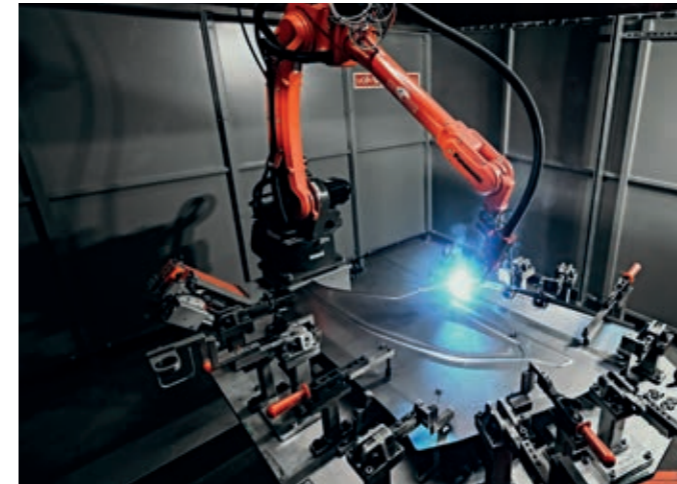
Svařování plechových podestav.
