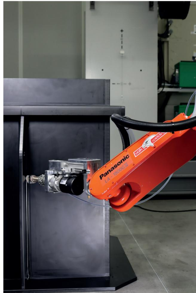
spezialisiert. In den letzten Jahren haben wir dieses Wissen genutzt, um eine Lösung anzubieten, die die Automatisierung des Kunststoffschweißprozesses ermöglicht.
